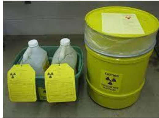
RAJAH 6: Contoh tong dan plastik untuk menyimpan sisa radioaktif
