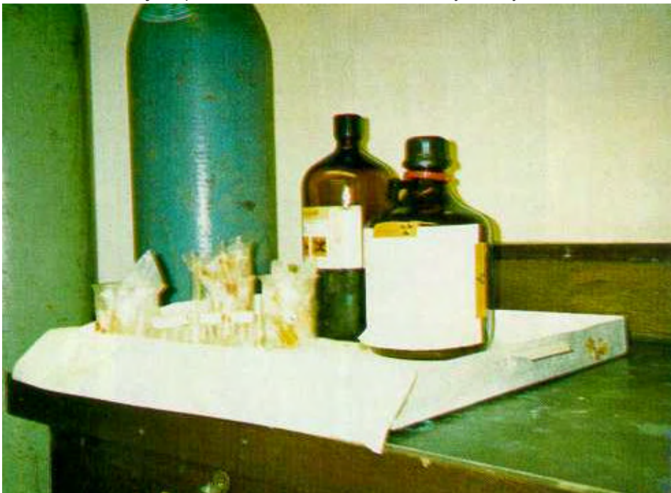
Contoh botol 'Winchester' yang boleh digunakan untuk menyimpan sisa radioaktif cecair.
